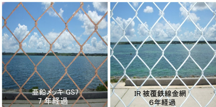
図-2 メッキ金網と IR 被覆鉄線金網の比較
