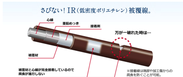
図-1 IR 被覆鉄線金網の構造
