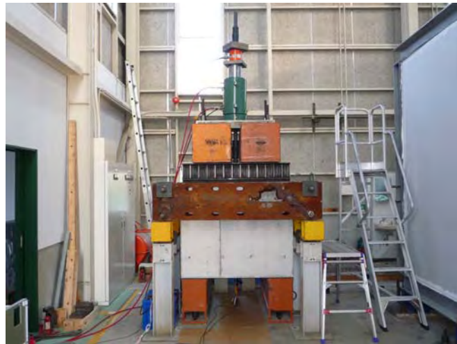
写真 4.34 試験実施状況 試験体 : SH490-No.3 最大荷重時
