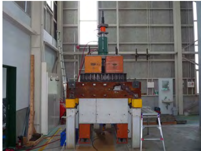
写真 4.13 試験実施状況 試験体 : SH685-No.2 最大荷重時
