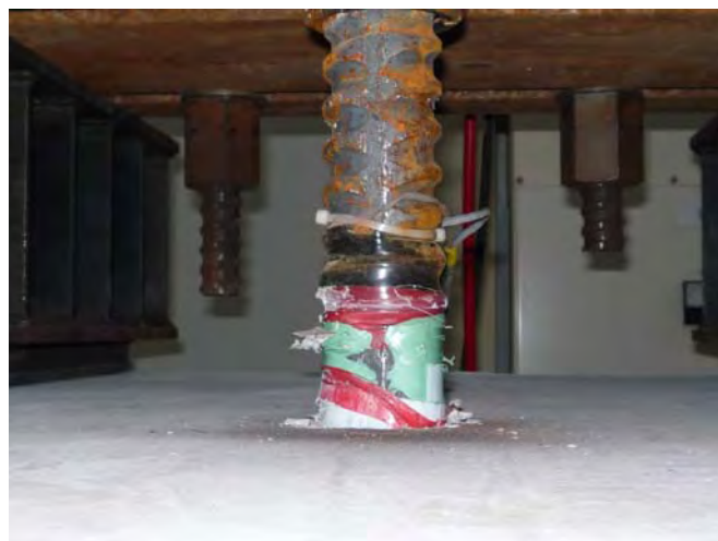
写真 4.15 試験実施状況 試験体 : SH685-No.2 鉄筋の最終拔出し状況
