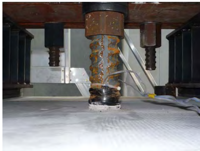
写真 4.35 試験実施状況 試験体 : SH490-No.3 鉄筋の拔出し状況 (1回目上限応力時)
