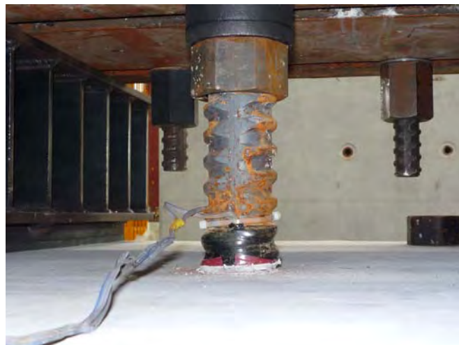
写真 4.14 試験実施状況 試験体 : SH685-No.2 鉄筋の拔出し状況 (1回目上限応力時)
